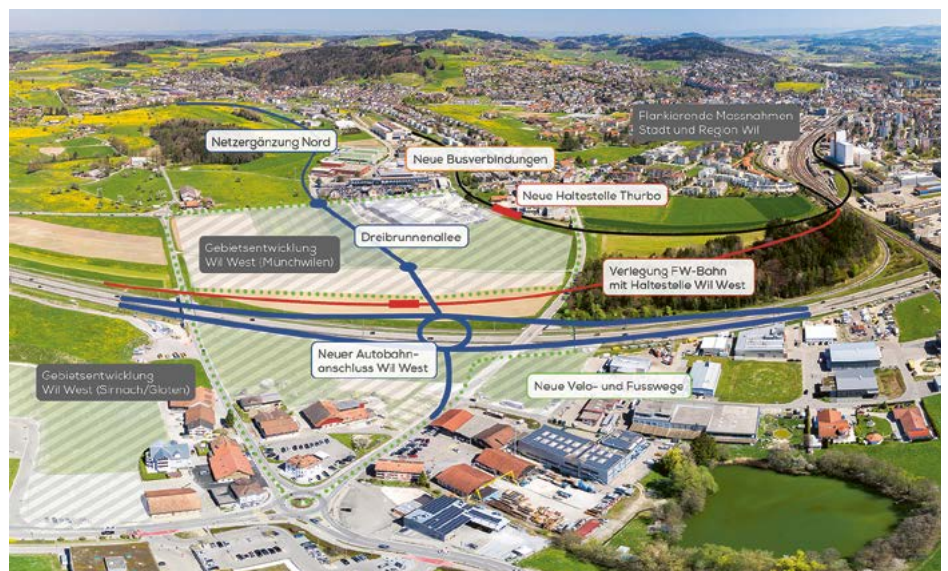
Massnahmen der Standortentwicklung Wil West. Hinten links Bronschhofen, hinten rechts Stadt Wil, im Vordergrund Sirmach/Gloten.
